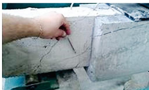
b) Fissura de cisalhamento no apoio de viga
