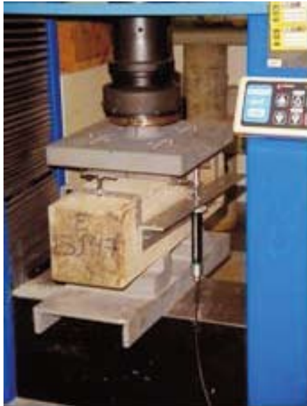
Figura 2 - Aparato do ensaio de cisalhamento direto posicionado no equipamento de ensaio
