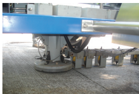
Figura 2 – Testes com FWD com posicionamento de carga em juntas
