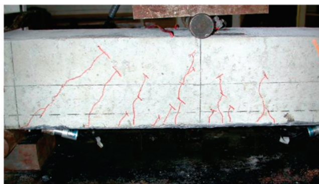
a) fissura principal no final do reforço
