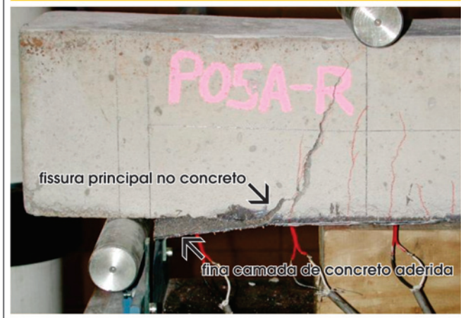
Figura 1 – Ruína de viga reforçada por descolamento (Ferrari (1))
