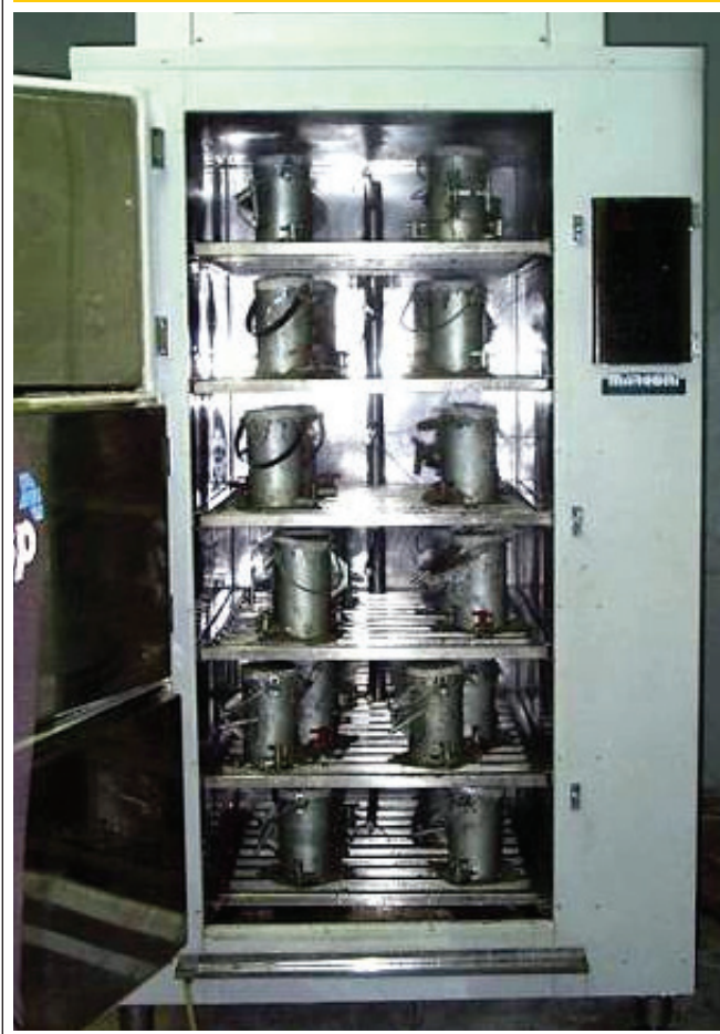
Figura 4 - Equipamento de cura térmica a vapor em funcionamento com os corpos-de-prova distribuídos nas prateleiras
