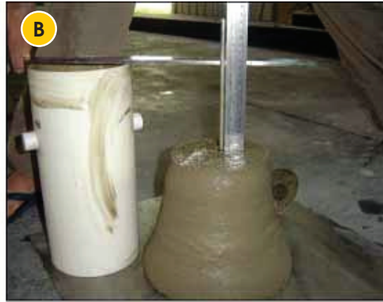
Figura 6 – Fases do procedimento de ensaio utilizado para a técnica de Pashias: (a) cilindro pronto para ser elevado; (b) cilindro retirado e medida do abatimento
