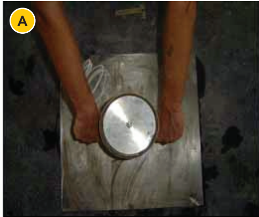
Figura 6 – Fases do procedimento de ensaio utilizado para a técnica de Pashias: (a) cilindro pronto para ser elevado; (b) cilindro retirado e medida do abatimento
