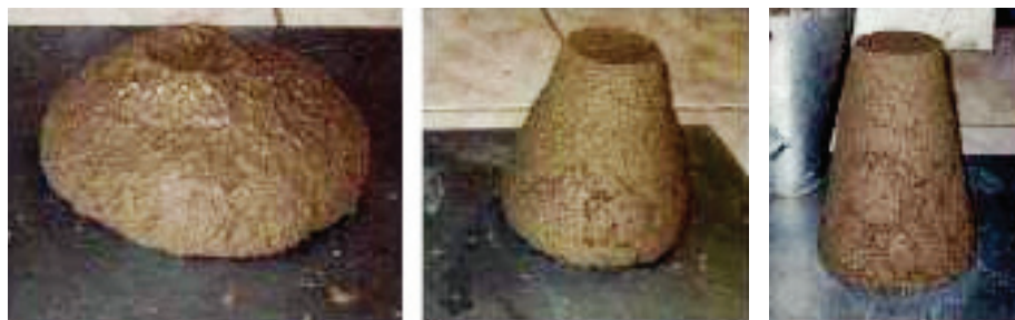
Figura 19 – Perda de abatimento contínua e gradual durante o tempo de medida do ensaio
