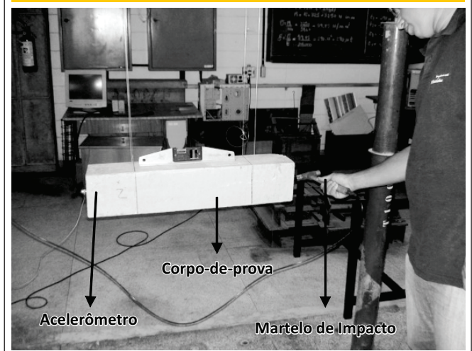
Figura 9 – Arranjo de ensaio dinâmico para corpo-de-prova prismático empregado nos ensaios na LE-EESC
