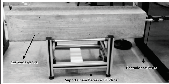
Figura 7 – Aparato para ensaio dinâmico de corpo-de-prova prismático empregado nos ensaios na ATCP
