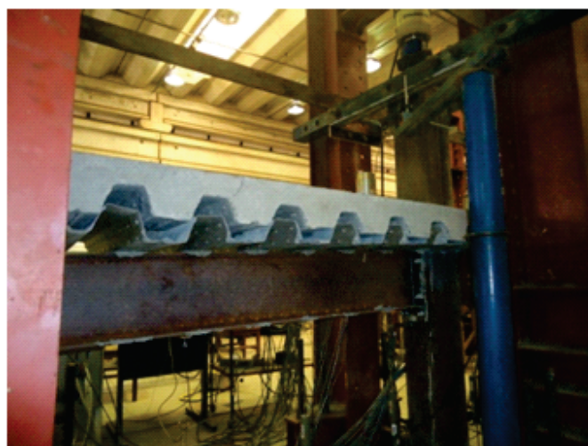
Figura 10 – Ruptura da ligação viga-laje
