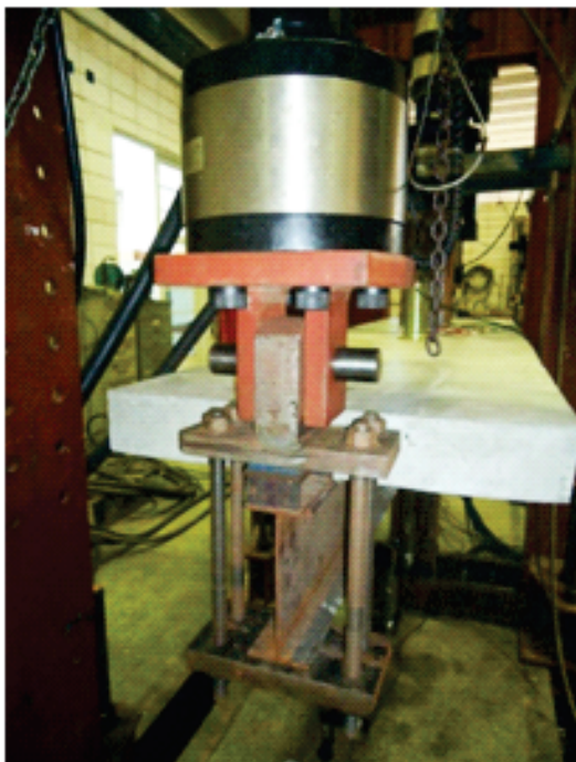
Figura 8 – Rótula utilizada para aplicação da força das vigas
